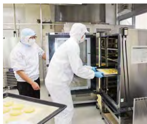
スチームコンベクションオープンに天板を装入
